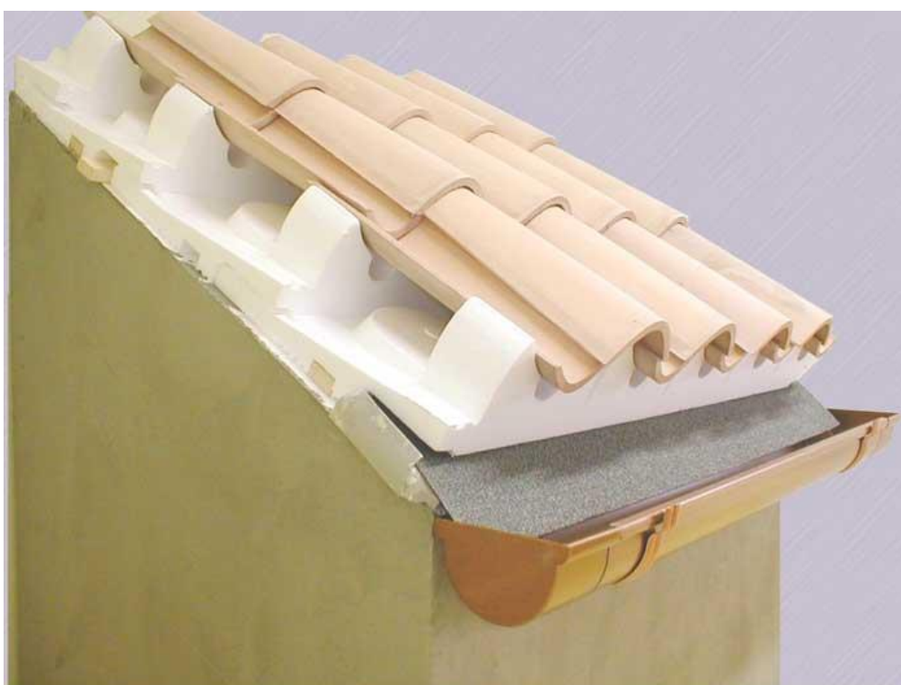
Figura 2 – Rappresentazione schematica di un tetto a falde termoisolato con EPS
