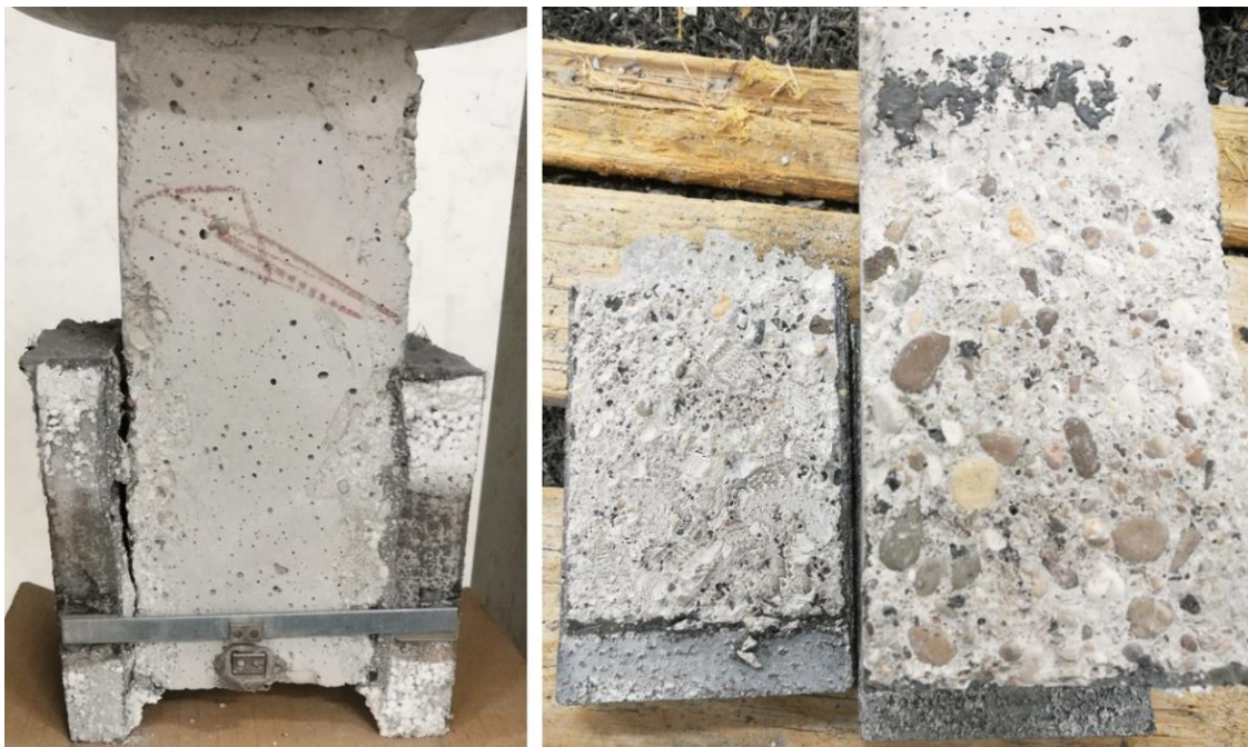
Figura 9 – Modalità di rottura tipicamente riscontrata dopo le prove: rottura interna al supporto
