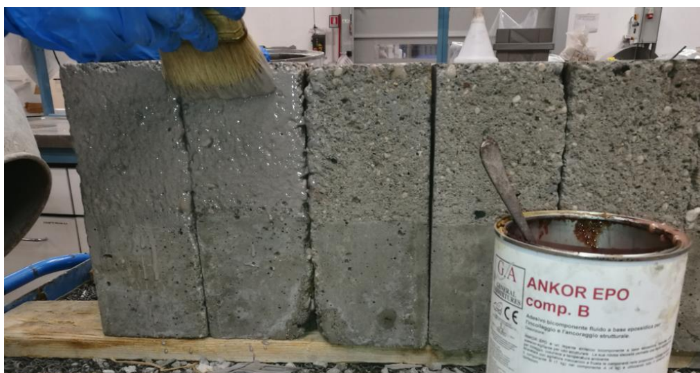
Figura 4 – Applicazione del prodotto per incollaggi strutturali e riprese di getto ANKOR EPO sulla porzione di superficie destinata al contatto con COMPOSITE M130.
