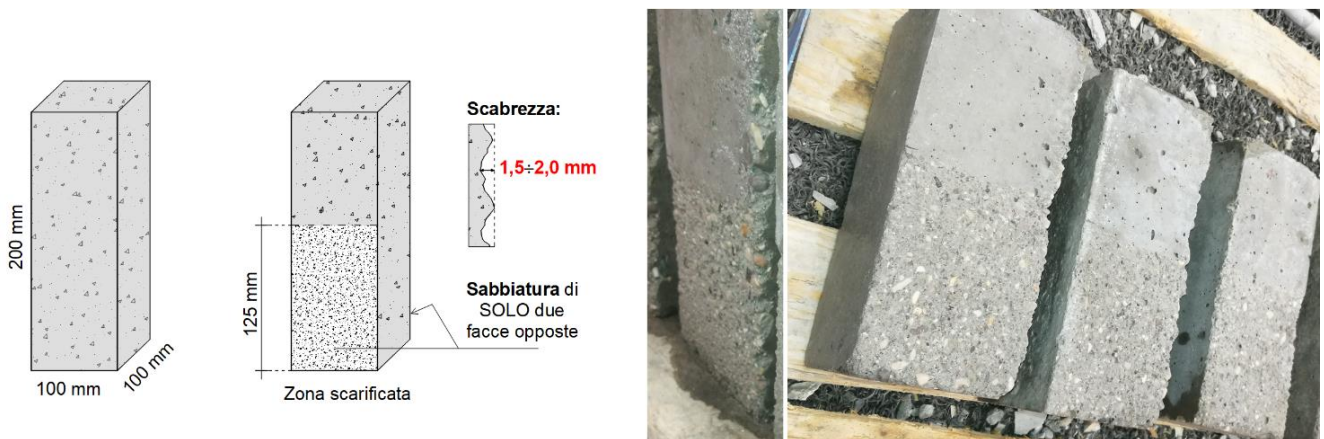
Figura 3 – Provini di calcestruzzo scarificati prima di essere sottoposti ad un getto aderente di COMPOSITE M130.
