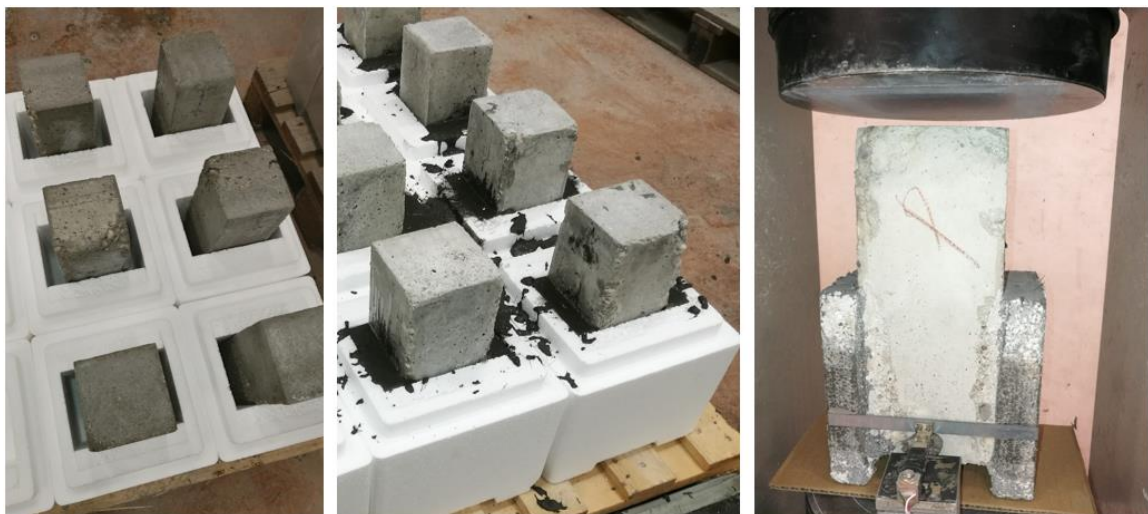
Figura 6 – Alcune fasi di preparazione dei campioni. Da sinistra a destra: posizionamento dei prismi di calcestruzzo nelle casseforme, esecuzione del getto di COMPOSITE M130 e preparazione al test.
