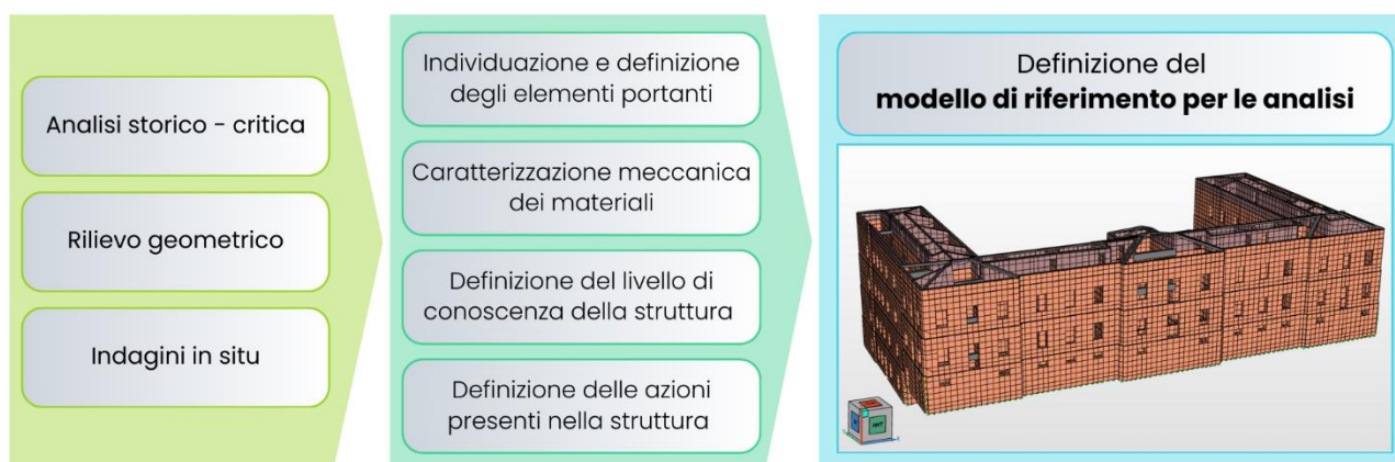
Figura 14 Fasi di definizione del modello di calcolo
