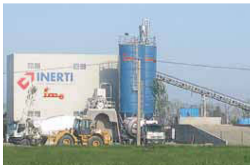
INERTI S.r.l. Molino di Malandriano (PR) Impianto tipo: Premix 6 Produzione: 120 mc/h
