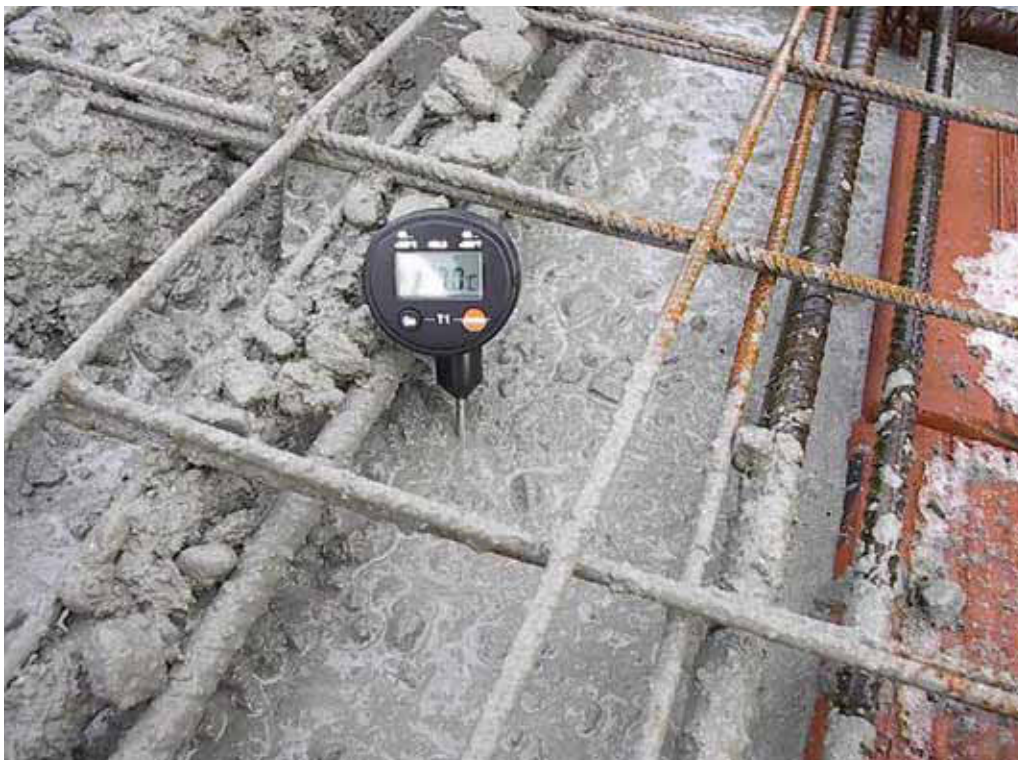
Fig. 1 – Temperatura del calcestruzzo leggermente superiore del minimo imposto dalla UNI EN 206-1 (+5°C).
