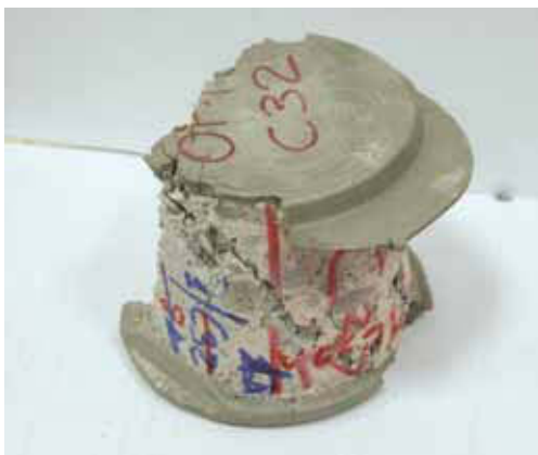
Fig. 4 - Carota dopo la prova; evidente la rottura diagonale di tipo I o J (UNI EN 12390-3) - Insufficiente attenzione ai procedimenti di prova.
