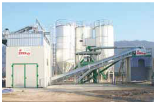
COLABETON S.p.A. Cologne Bresciano (BS) Impianto tipo: Premix 5 Produzione: 120 mc/h
