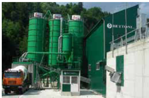
BETTONI S.p.A. Forno Fusorio Azzone (BG) Impianto tipo: Premix 5 con riciclaggio Produzione: 120 mc/h
