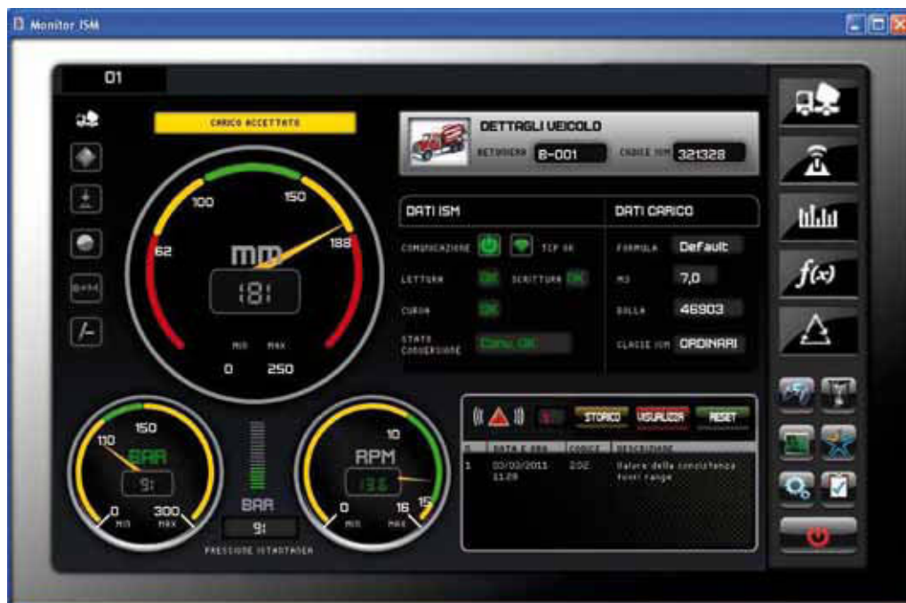
Fig. 4 - Cruscotto operativo del sistema di controllo "ISM".
