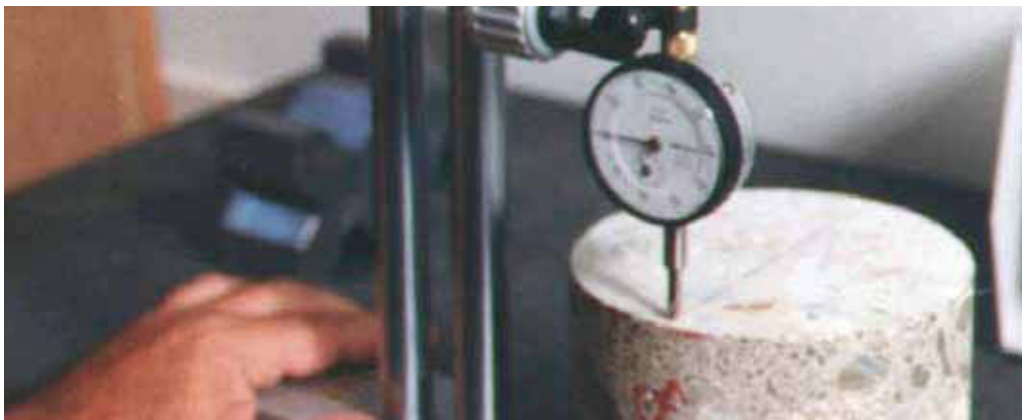
Fig. 3 - Impiego del comparatore.
