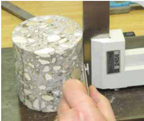
Fig. 2 - Controllo della perpendicolarità e della planarità mediante lamelle calibrate. Carota cappata a zolfo.
