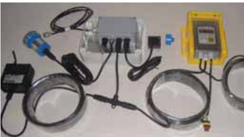
Fig. 6 - Kit componenti con bus a 4 conduttori.
