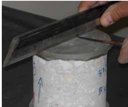
Fig. 2 - Controllo della perpendicolarità e della planarità mediante lamelle calibrate. Carota cappata a zolfo.
