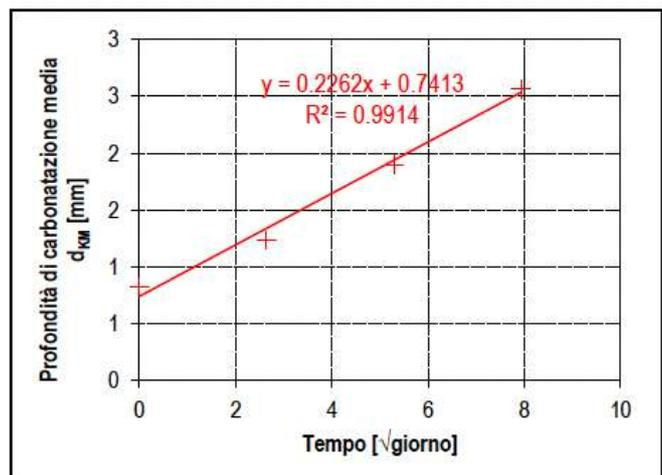
Note: Il calcestruzzo è stato confezionato con rapporto acqua/cemento = 0.60. Il campione è stato rivestito con il prodotto Penetron Standard secondo le raccomandazioni di Penetron Italia Srl
