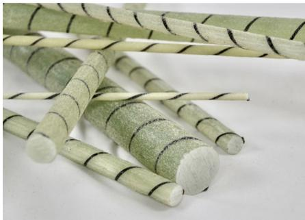
Le barre in vetroresina **GLASSPREE®** sono realizzate tramite un processo continuo di pultrusione; l'elemento di rinforzo è costituito da fibra di vetro direct roving "E-CR", resina vinilestere e rivestimento esterno in sabbia di quarzo.
