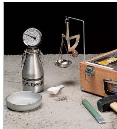
Fig. 3.5 - Lo strumento più attendibile per la misurazione dell'umidità residua del massetto è l'igrometro al carburo
