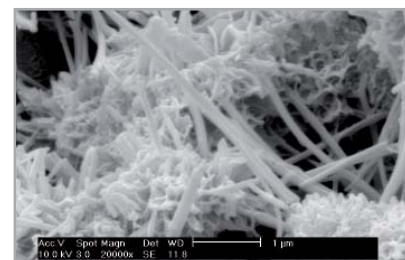
Immagine al microscopio elettronico della struttura di un massetto tradizionale in sabbia e cemento
