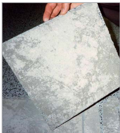
Fig. 3.4 - Distacco di ceramica su massetto polveroso
