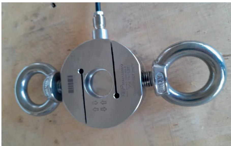
Figura 7.2.2.2-1 Cella di carico da 500 kg
