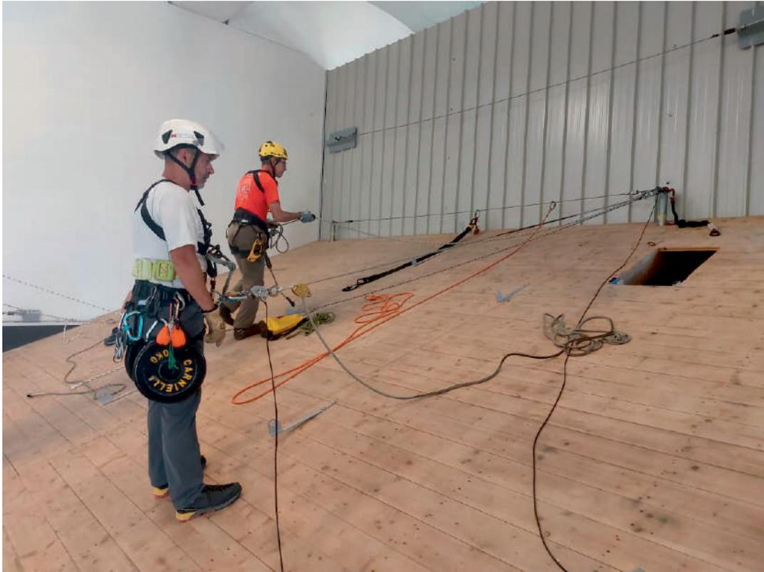
Figura 7.2.2.3-2 - Sistema di posizionamento sul lavoro e di salvataggio - Struttura di prova
