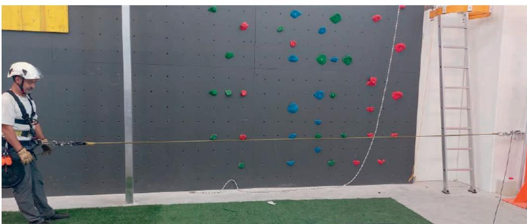
Figura 7.2.1-12 - Sistema di trattenuta - Condizione di utilizzo
