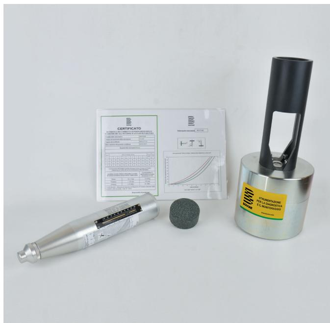
Figure 2 - Apparecchiatura Sclerometro
