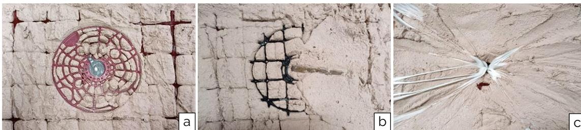
**Figura 6.** Tipologie di connettore testate: a) ARMIS ALL-IN-ONE; b) Connettore preformato con apposito fazzoletto di ripartizione; c) connettore semi-impregnato.
